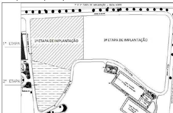
Figura 150. Etapas de implantação das células de Aterro Sanitário da Bacia Norte
