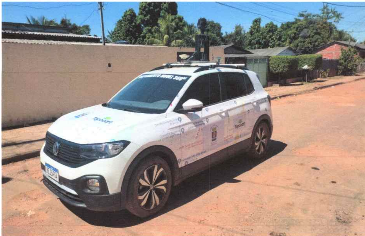
Foto 6: Levantamento de Fotos – 360° Terrestres - Unidade Veicular
