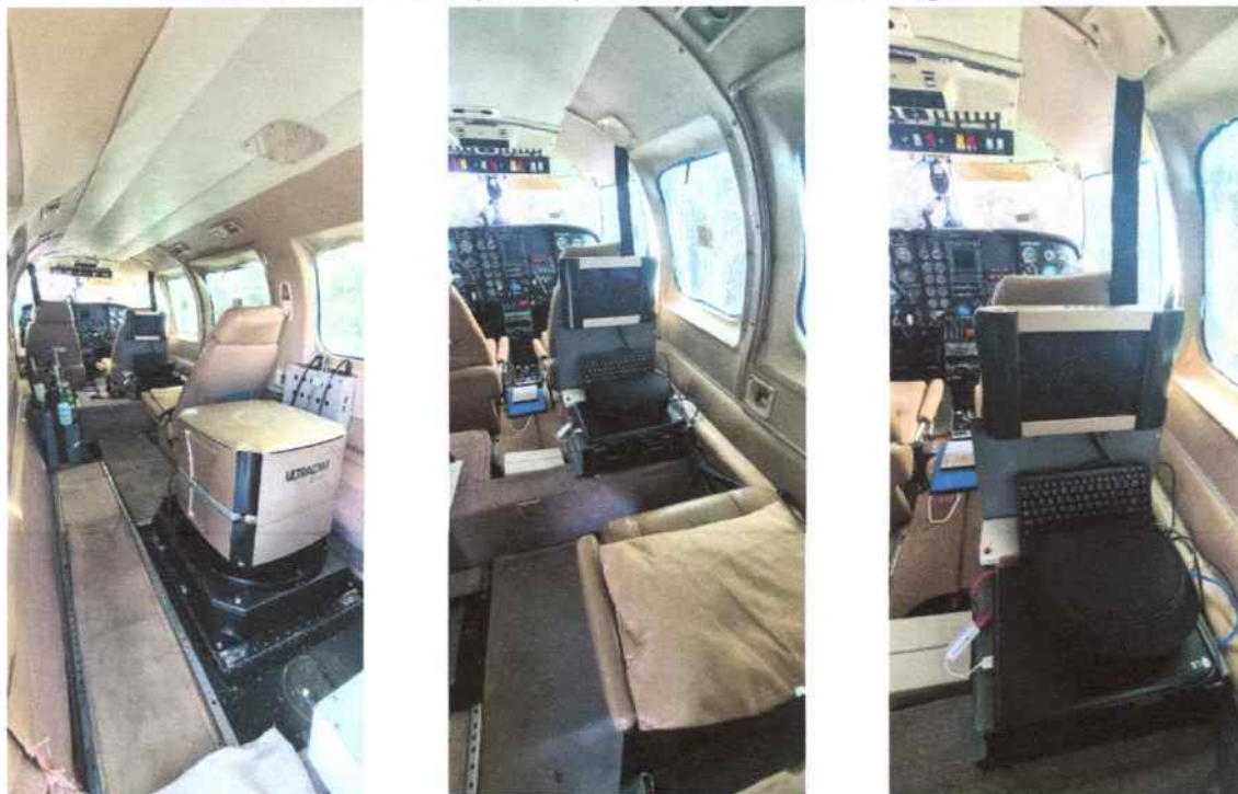
Foto 3: Aeronave Adaptada para Missões Aerofotogramétricas
