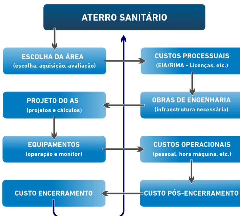
Figura 39– Fluxograma para implementação do aterro sanitário.
